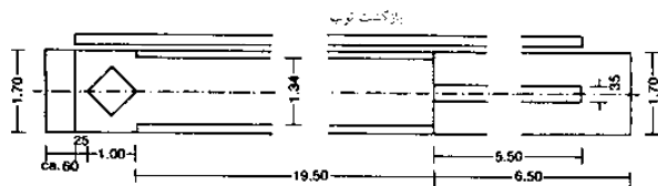
(۲) ساختار مسیر دارای کانال‌های جانبی
