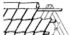
(۱۲) سقف تمام سفالی سبک‌تر 0.50 \text{ KN/m}^2
