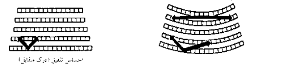
(۳) توازن صندلی‌ها در یک ردیف، با عرض‌های صندلی‌های مختلف به دست می‌آید (0.50-0.53-0.56)
