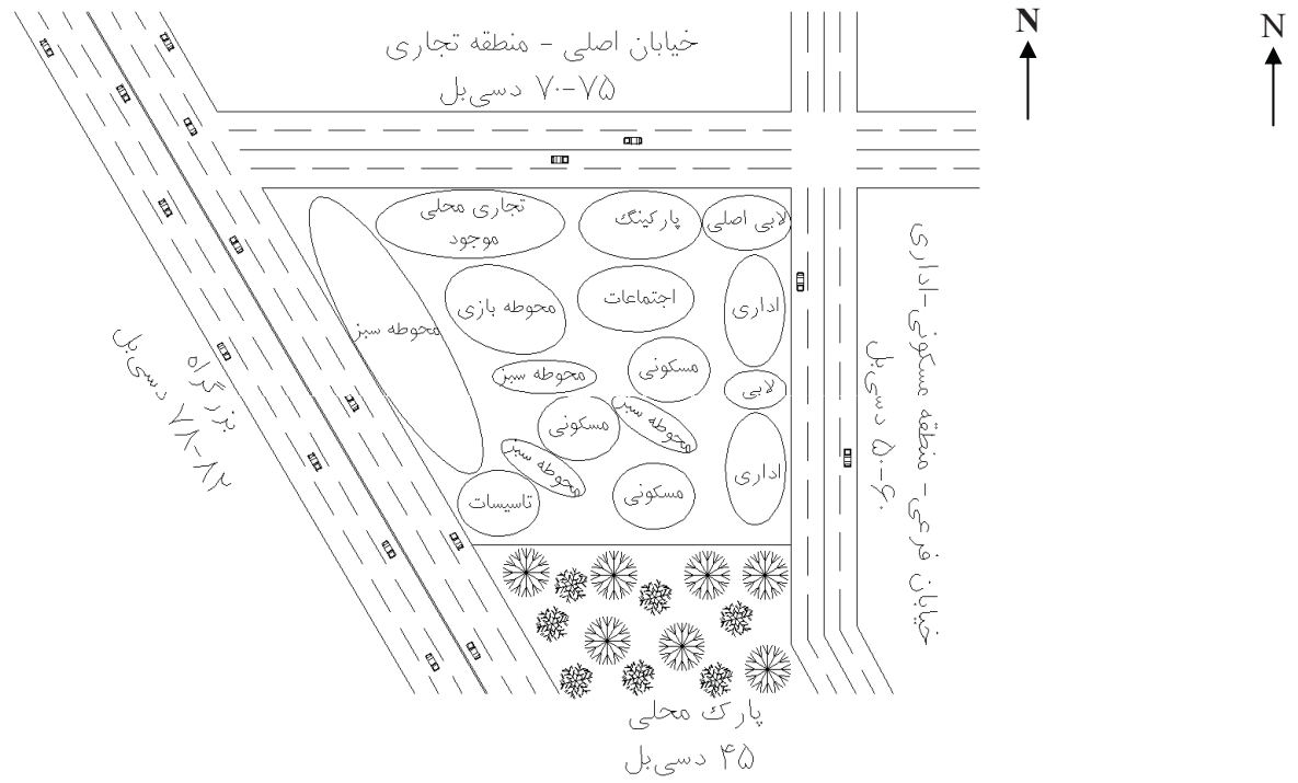
شکل پ-۱-۷: جانمایی محوطه و استقرار فضاها در یک مجموعه مسکونی - اداری
